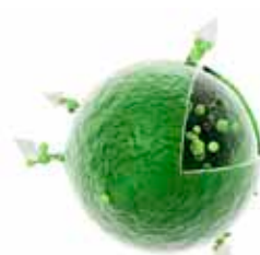
Mikrokapslar med biocider i färgen hindrar blå havstulpaner att fästa. Foto: Capeco.
